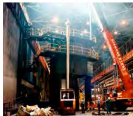
全球最大的螺栓型Superbolt超级螺栓预紧器安装在双柱式锻压机上。
