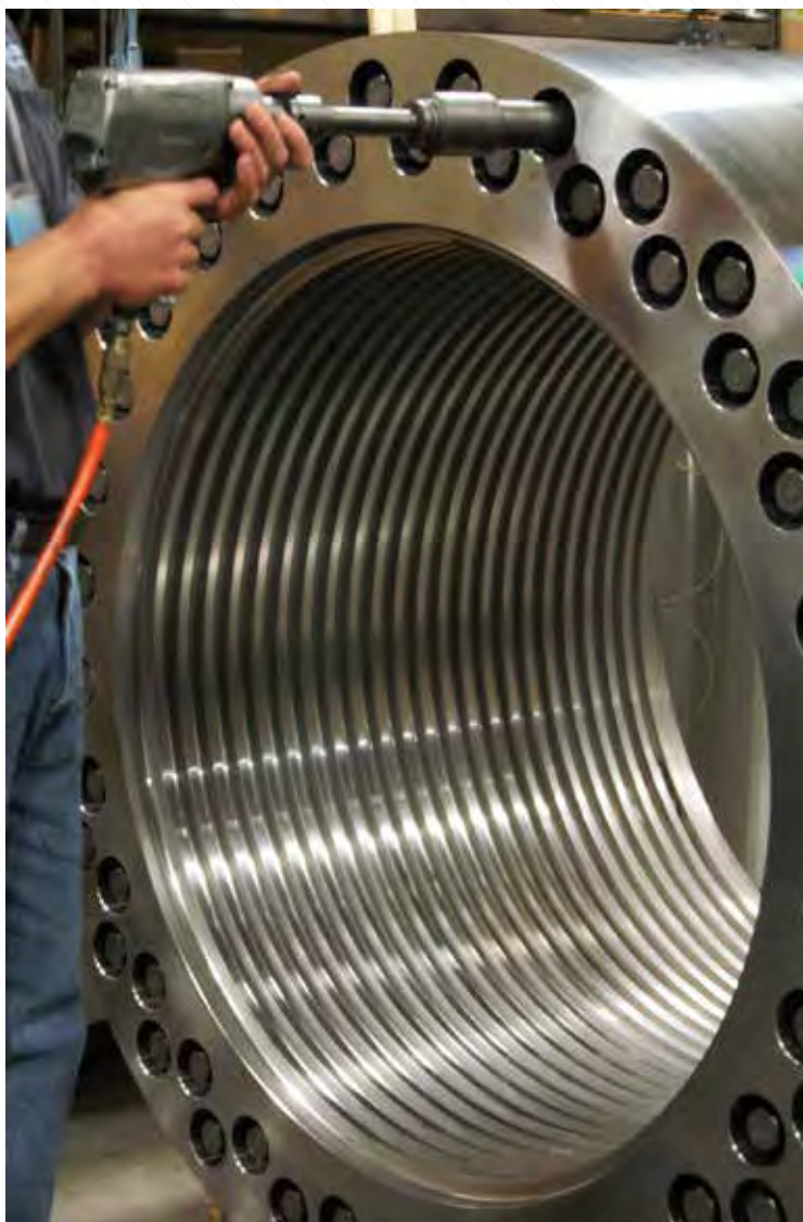
装配1016mm(40英寸)超大型螺纹预紧器，用来固定50,000吨的压力机。
